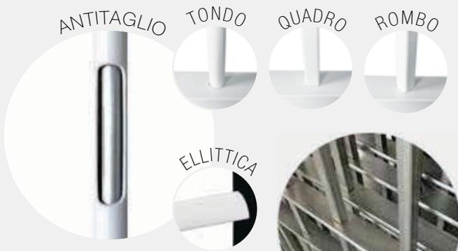
Sbarre in tubolare di sezione tonda, quadra, a rombo o ellittica da 14 mm, zincate, con anima antitaglio integrata e con la possibilità di decorarle con lavorazioni estetiche come: torsioni, pieghe, curve, borchie, pigne, forgiature, ecc.
