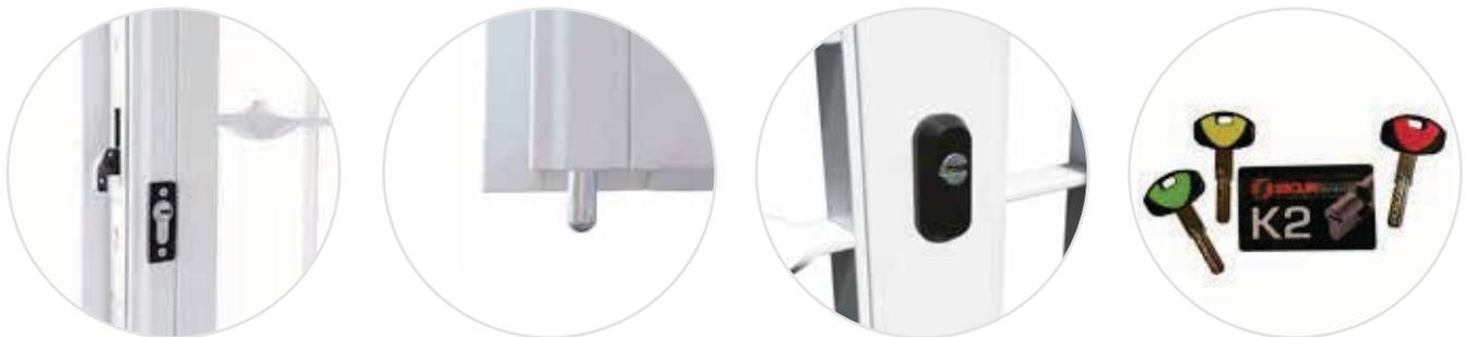
Serrature a tre punti di chiusura, unificate di serie in maniera esclusiva per appartamento, con catenaccio basculante con gancio in acciaio rinforzato (per aumentare la resistenza all'effrazione anche in caso di divaricazione), cilindro di sicurezza personalizzato a chiave europea, rinvio di chiusura superiore ed inferiore con corsa maggiorata, a 26 mm, perni di inserimento nel telaio da 12 mm.
